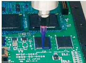
ディスペンサーによる部分塗布 (一例)
