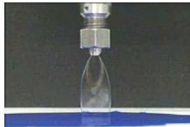
エレップコートの吐出状態:カーテンコートノズル
